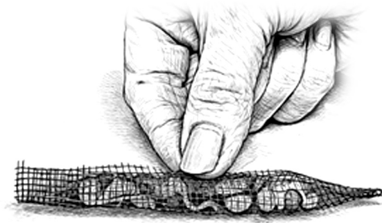
Figure 2 : fermeture du grillage
