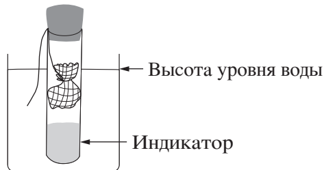
Рисунок 3: мешочек в пробирке, находящейся в ванночке.
